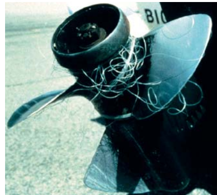
Costosa fué la reparación de estos propulsores que quedaron enredados en líneas de monofilamento.
